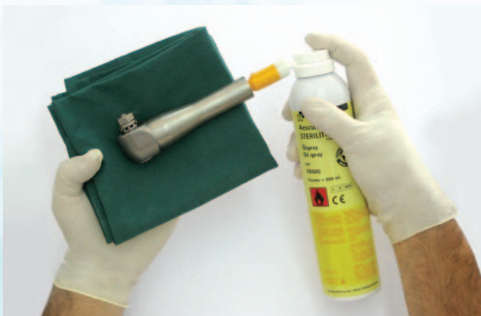
ej. lubricación del interior de la sierra oscilante micro-line GB129 con Sterilit® GB600 y adaptador GB600810
