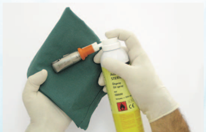
ej. lubricación del interior de la sierra mini-line GB390R con Sterilit® GB600 y adaptador GB600830
