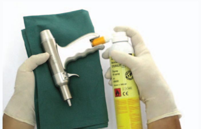
ej. lubricación del interior del taladro micro-line GB200 con Sterilit® GB600 y adaptador GB600810
