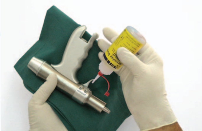
ej. lubricación del gatillo del taladro GB200 con Sterilit® M GA059
